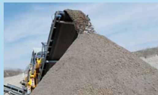
Значительная высота разгрузки материала (до 4 метров) обеспечивается конструктивными особенностями установки
