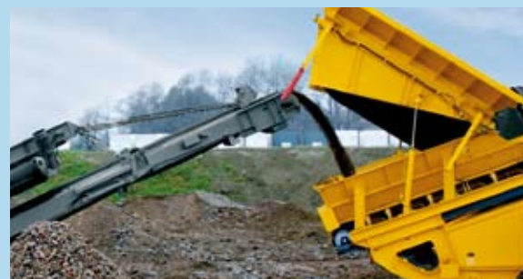
Подача дроблёного материала в TS3600 напрямую с дробильных установок компании RUBBLE MASTER
