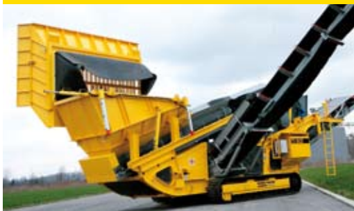
Загрузочный бункер оснащён колосниковой решёткой, имеющей возможность регулировки с помощью пульта дистанционного управления
