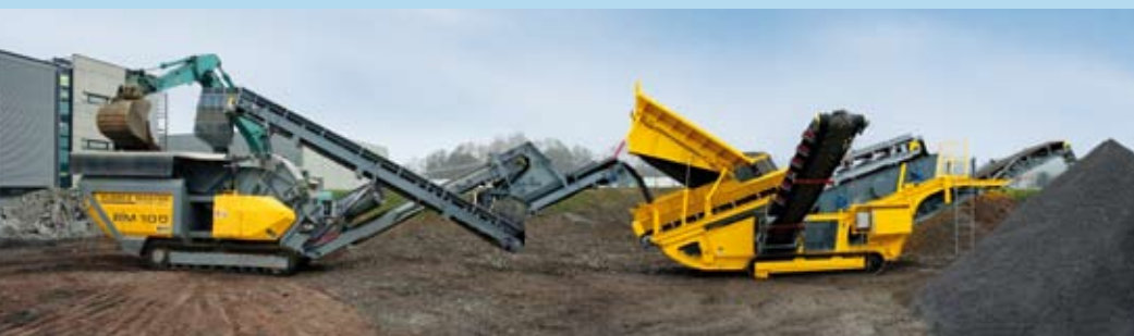
Совместное использование дробильной установки RM100 с отделителем негабаритной фракции OS100, обратным конвейером возврата негабаритной фракции и виброгрохота TS3600
